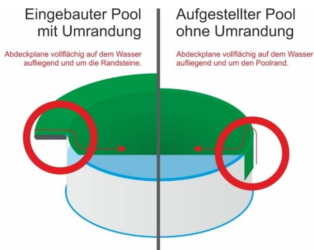
Achten Sie bitte darauf, dass die Abdeckplane richtig befestigt / beschwert wird, da diese sonst durch Schneelast oder starkem Wind in den Pool fallen kann.
