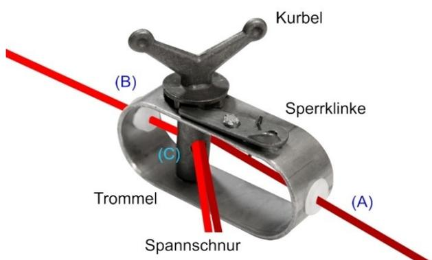
Anschließend führen Sie eines der Seilenden durch die Öffnung A des Spannschlusses, das andere Ende durch die Öffnung B. Abschließend ziehen Sie beide Seilenden durch die Öffnung C der Spannschlosstrommel und verknoten Sie diese. Bei Bedarf kann die Länge der Spannschnur gekürzt werden.
